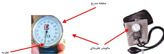
شکل ۸: دستگاه فشارسنج عقربه‌ای (aneroid monitor)
